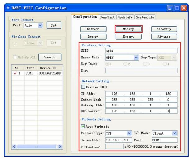
Figure 3-3 Modify parameters of UART-WIFI module
